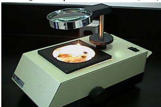
Figure 4. Compteur de colonies Accu-Lite (Fisher)
